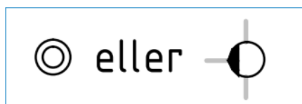
Figur 3.3 Två förslag till bräddavlopp
