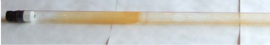
Figur 4.8. Beleggdannelse på kvartsrør (A. Seim, 2008)
