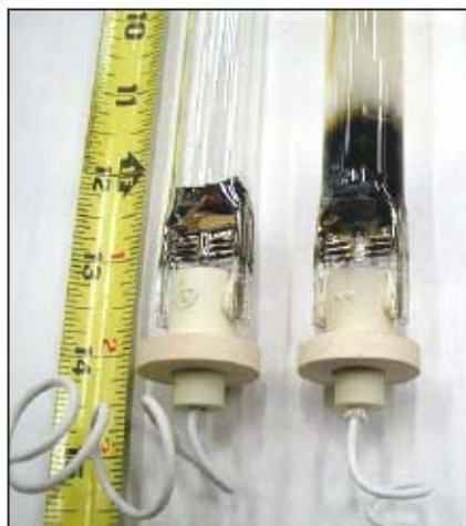
Figur 4.5. Ny (til venstre) og gammel (aldret) UV-lampe (USEPA 2006; Mackey et al. 2004)
