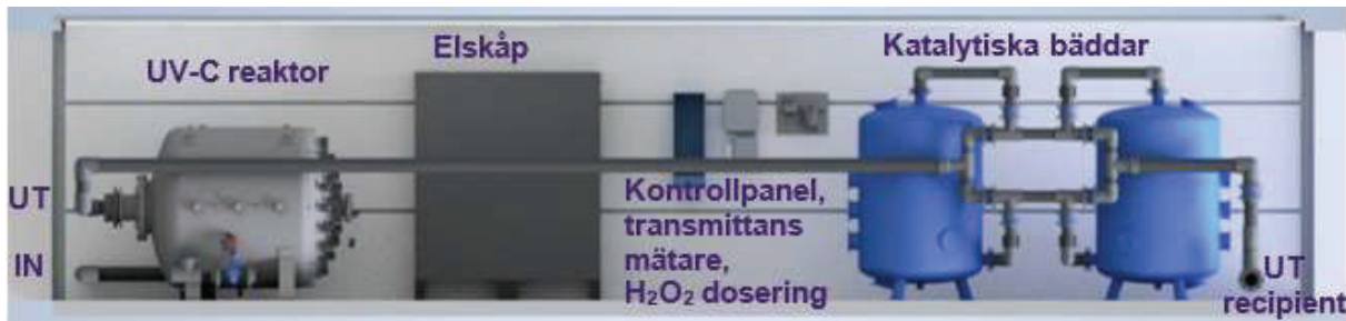
Figur 8 Schematisk översikt över Advanox™-piloten (bild från Van Remmen UV Technology).
