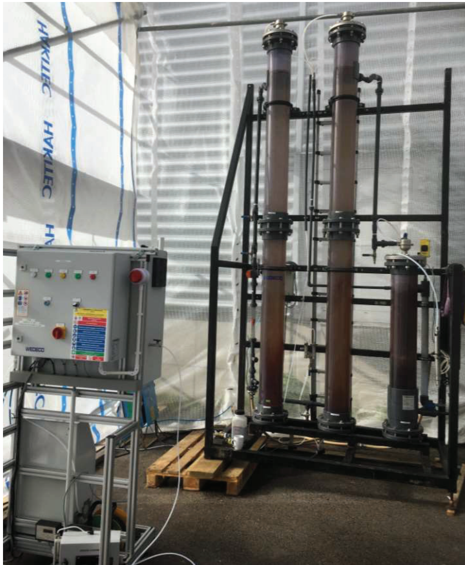
Figur 6 Pilotanläggning med ozongenerator och bubbelkolonner
