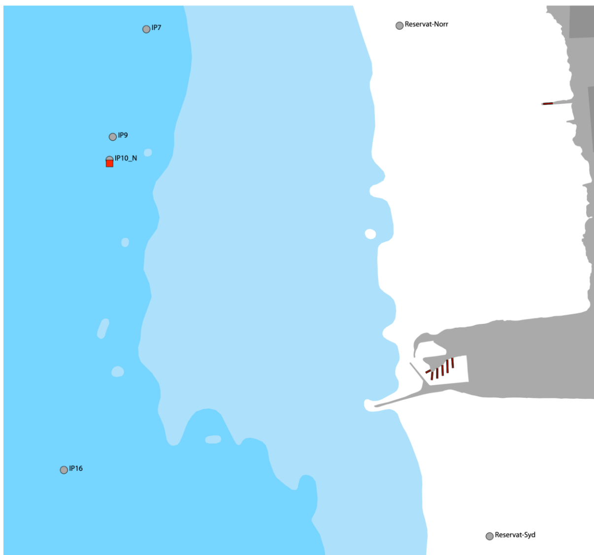
Figur 9 Punkter i undersökningen där recipientvatten provtogs. Reningsverkets utsläppspunkt är markerad med en röd kvadrat.
