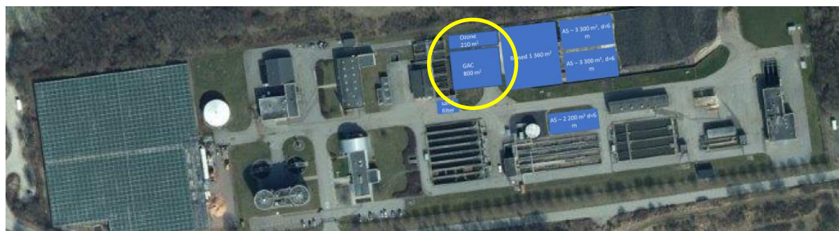
Figur 6 Möjlig placering och ytbehov för avancerad rening vid Klagshamns avloppsreningsverk (gul ring) i förhållande till föreslaget komplettering med aktivslam.
