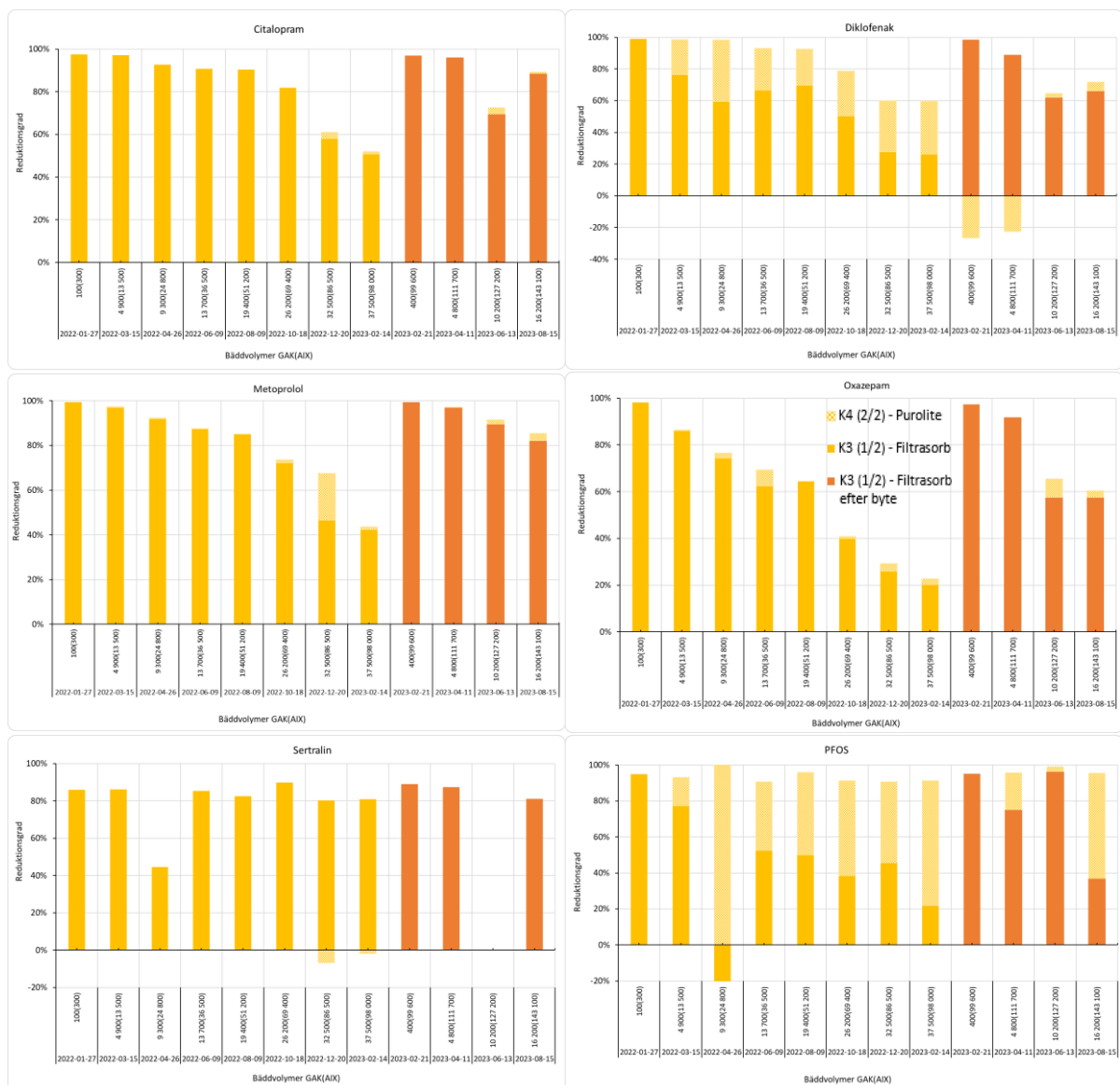
Figur 16. Reduktion av citalopram, diklofenak, metoprolol, oxazepam, sertralin och PFOS mot antal behandlade bäddvolymer (BV) över driftlinje L2 (K3, Filtrasorb 400 följt av K4, Puralite 694E) i kolonnförsöken. Varje stapel motsvarar driftlinje L2. Olika nyanser av gult markerar de olika kolonnerna, GAK respektive AIX. En mörkare färg används för reduktionen över GAK efter byte av material.
