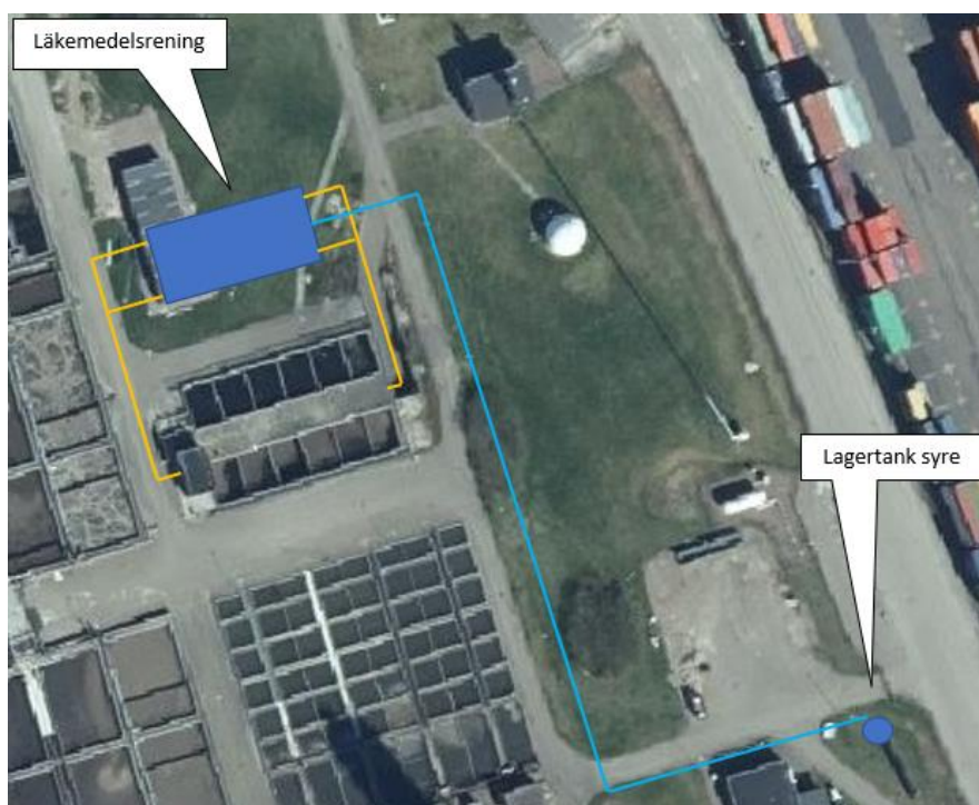
Figur 5. Lokalisering av läkemedelsreningen på Öresundsverket med tillhörande syrgastank för flytande syre.
