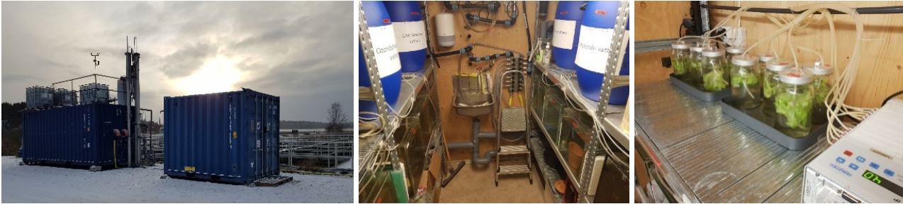
Figur 11 Foton visande försöksanläggning för zebrafisk och dammsnäckor. Försöken utfördes i inredd exponeringscontainer (vänster). Fördelningstunnor för försöksvatten med fiskakvarier under (mitten). Glaskärl för exponering av dammsnäckor (höger).
