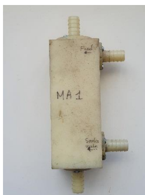
Figur 6.3: Hydrocyklon MA-1 med spolvatten för förbättrad separation av sand och aktivt kol
