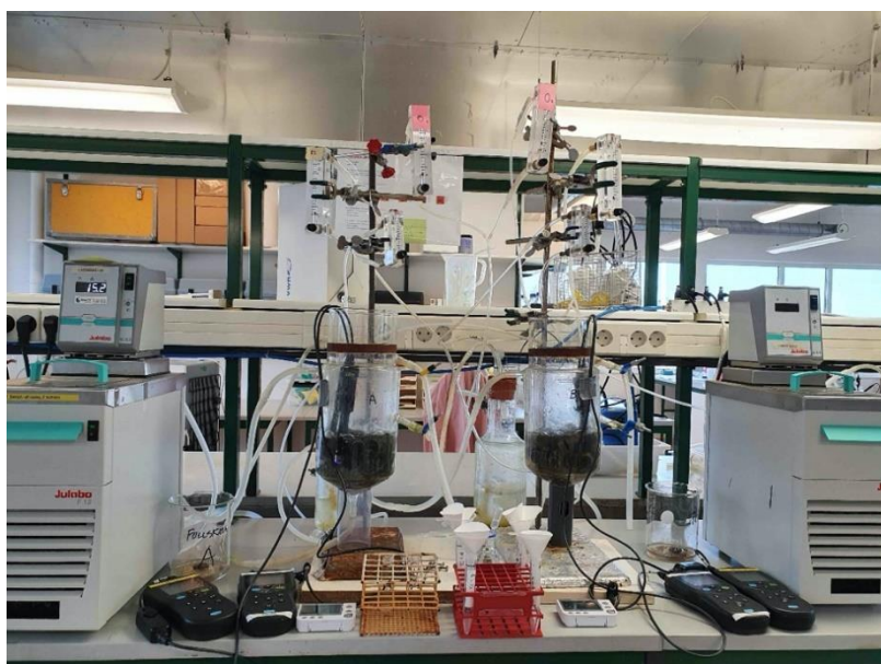
Figur 4.1: Representativ försöksupställning för läkemedelsrening med MBBR
