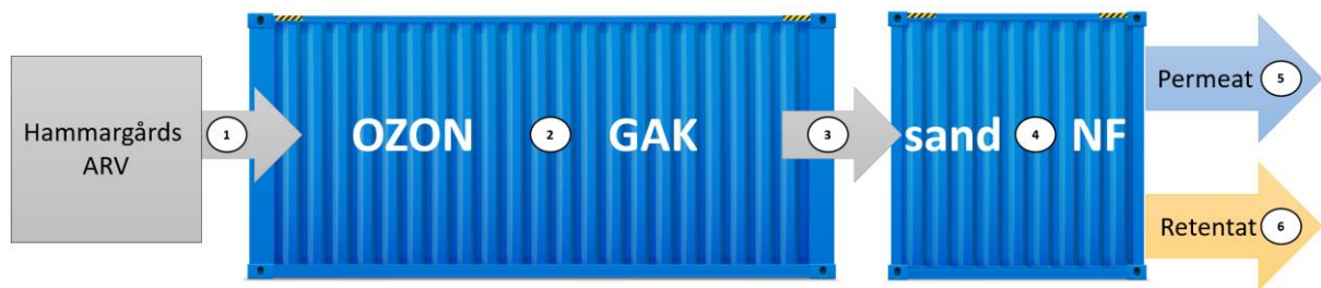
Figur 8. Schematisk bild av det containerbaserade avancerade vattenreningssystemet innehållande ozonering, adsorption med granulerat aktivt kol (GAK), sandfiltrering och nanofiltrering (NF), samt provtagningspunkterna 1–6.
