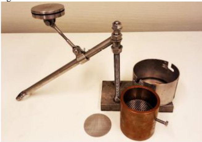
Figur 37. Press för att avvattna slam (Guo, 2017).
