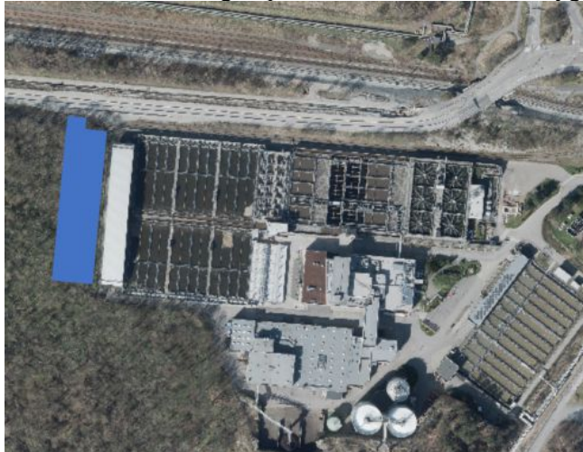
Figur 44. Skiss över förslag till placering av GAK-anläggning på Ryaverket med plats för container som behövs för byte av filter. (Skissen är ej skalenlig). Foto: Kartoteket, Göteborgs Stad.
