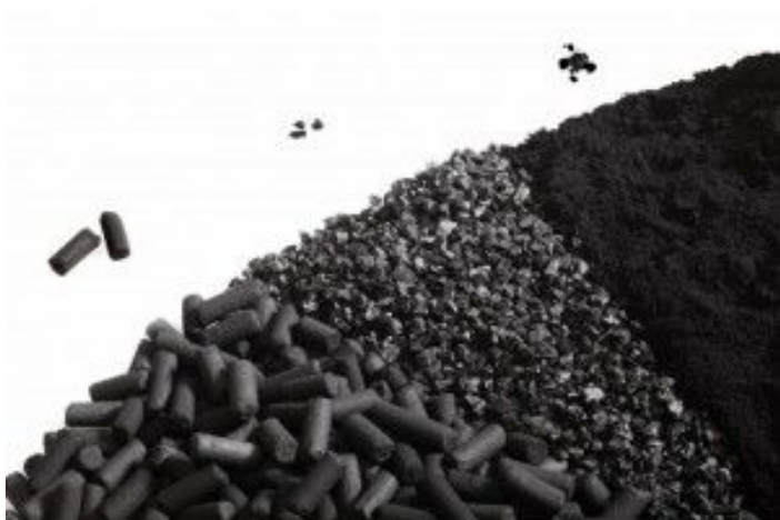
Figur 20. Olika former och strukturer av aktivt kol, från vänster till höger ses pelleterad/cylindrisk form, granulerat och pulveriserat aktivt kol. Källa: https://www.desotec.com/en/carbonology/carbonology-academy/activated-carbon-forms-and-shapes , besökt den 5 feb 2020.
