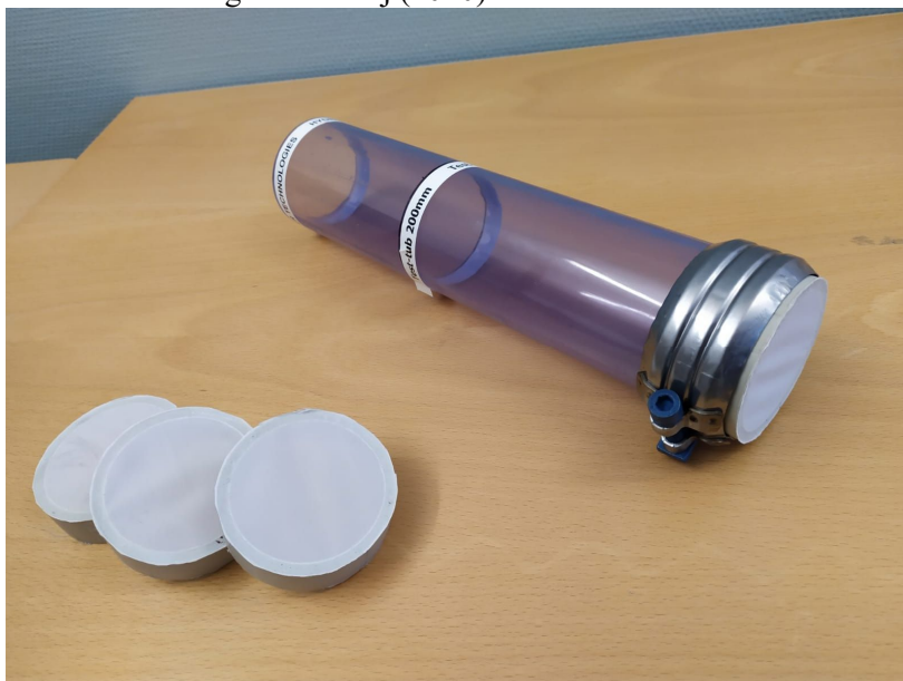
Figur 33. Testutrustning med 15 µm filter från Hydrotech.
