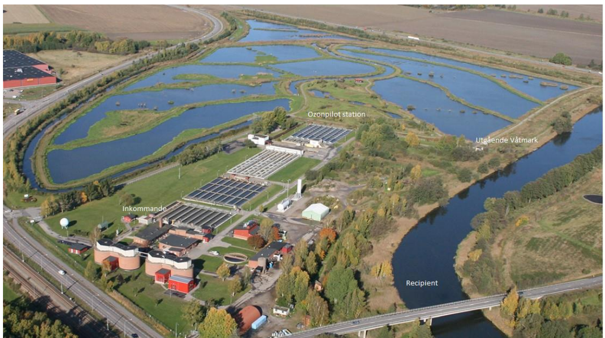
Figur 4. Ekeby ARV med våtmark och provtagningspunkten efter våtmarken (Utgående våtmark) i recipienten Eskilstunaån.
