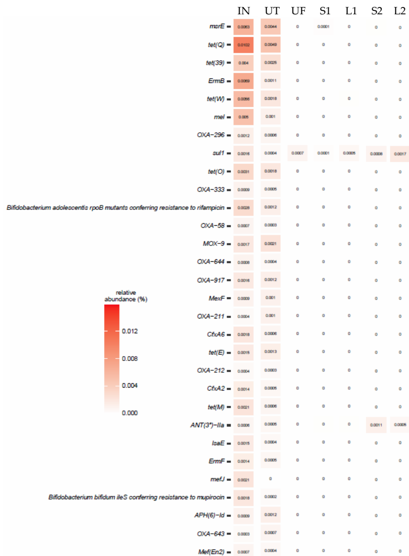
Figur 20. Halter av antibiotikaresistenta gener (AGR, baserat på Comprehensive Antibiotic Resistance Database) i förhållande till resterande identifierade gener (Provpunkter: IN – Getteröverket IN, UT – Getteröverket UT, UF – Ultrafiltrering, S1 – GPP20 filter 1/2, L1 – GPP20 filter 2/2, S2 – FS400 filter 1/2, L2 – FS400 filter 2/2).
