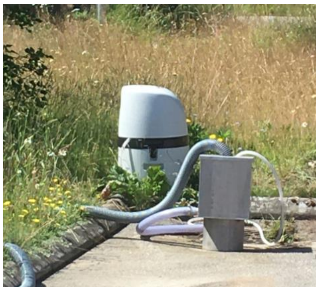
Figur 8 Portabel provtagare med uppsamlingsbehållare för provtagning efter kolfilter
