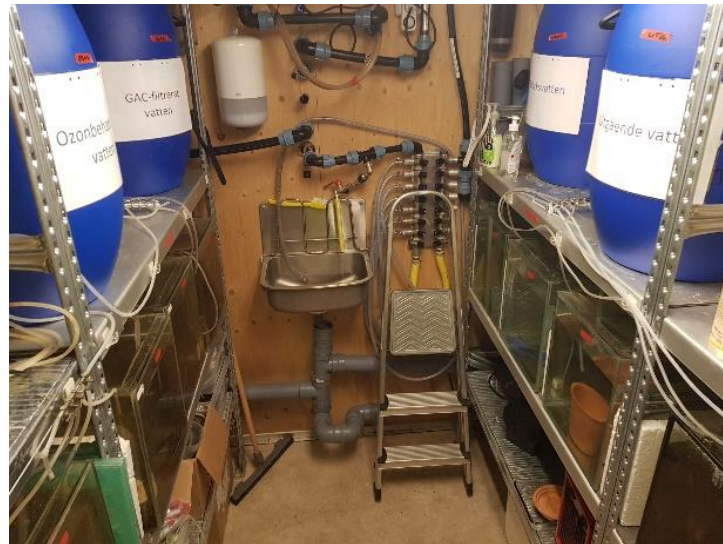
Figur 19 Försökscontainer visande fördelningstunnor och försöksakvarier för zebrafiskstudier.
