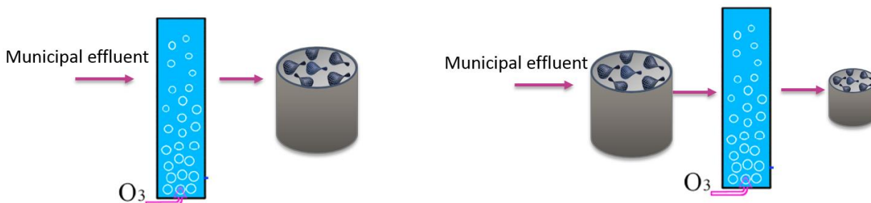
Figur 14: Ozon+MBBR eXenO 3 ™. Till vänster tvåstegsprocess, till höger trestegsprocess.
