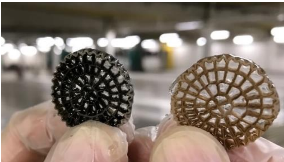
Figur 9. Bärarmaterial från pilotförsök vid Sjölanda avloppsreningsverk utförda inom RESVAV. Bäraren till vänster kommer från en reaktor med dosering av pulveriserat aktivt kol och bäraren till höger från en referensreaktor utan dosering.
