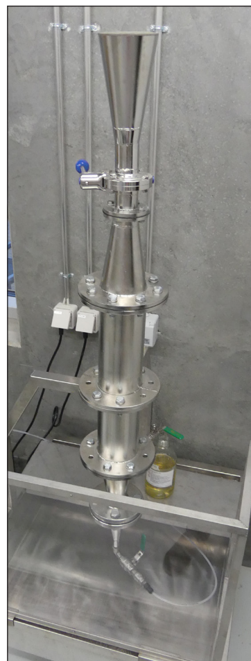
Figur 4.4a Specialbyggd utrustning för densitetsseparering av jord.
